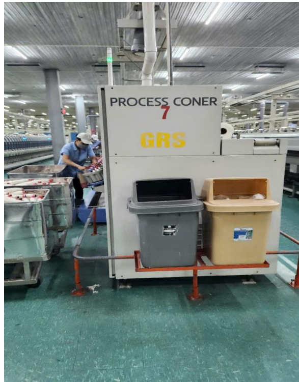
Hình 3.14. Thùng chứa bụi bông từ máy hút bụi trên cao
