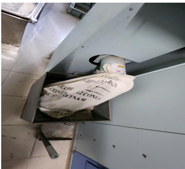
Hình 3.11. Bụi tinh và bụi bông được ép kiện
